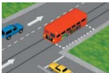
Zonas de seguridad demarcadas con líneas blancas discontinuas.
